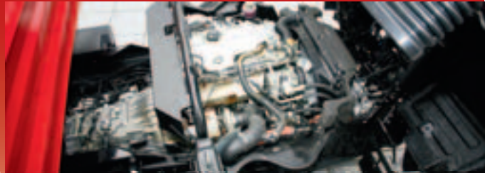
Den gleichmütigen Dreiliter-Diesel mit Common-Rail-Einspritzung gibt's in drei Leistungsstufen von 81 kW (110 PS) bis 107 kW (145 PS).
