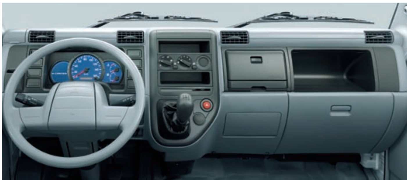
Übersichtliche Instrumentierung und Bedienung, verstellbares Lenkrad, Schaltung per Joystick – das Armaturenbrett des Canter.
