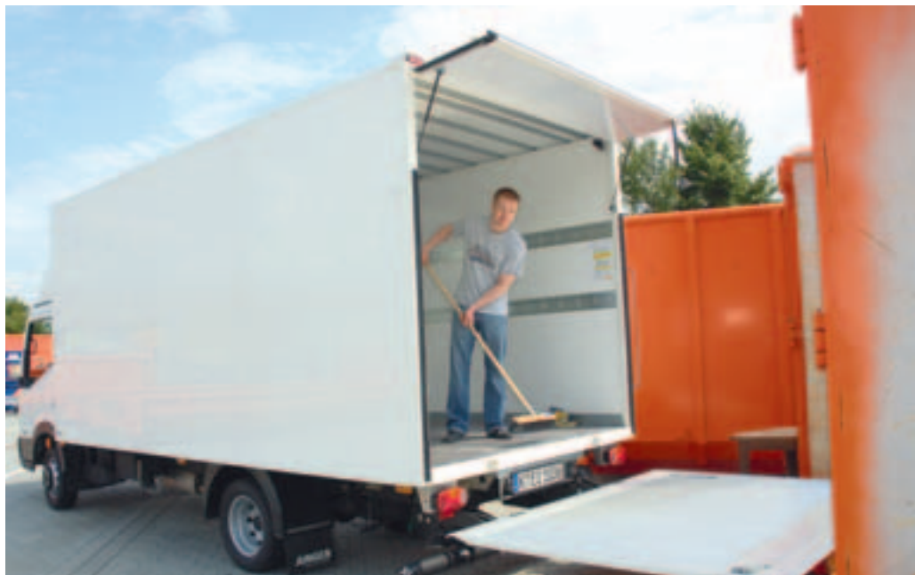
Der Cabstar bietet bei einer Fahrzeuglänge von 6,29 m etwa 4,60 m Ladelänge und ein Koffervolumen von rund 22,5 m 3 .
