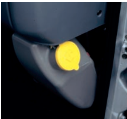
Nach japanischer Art gibt's überall Klappen, Deckel, Öffnungen: Scheibenwaschbehälter rechts im Einstieg.
