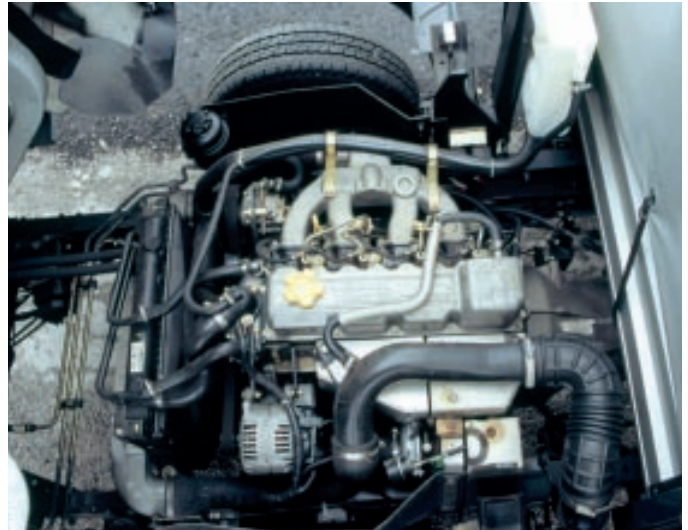
Ein Dieselmotor als braves Arbeitstier: Nissan-Vierzylinder unter der Kabine.
