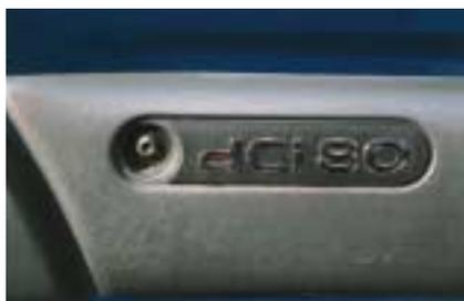
Das Kürzel dCi 80 steht für Common-Rail-Technik und 60 kW (82 PS) Motorleistung.
