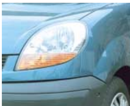
Die orangefarbenen Blinkleuchten unter den Klarglasscheinwerfern sind nun typisch für die Transporterversion vom Kangoo.
