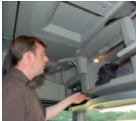
Das um 20 cm erhöhte Dach ermöglicht auch ein vergrößertes Staufachvolumen über der Windschutzscheibe.
