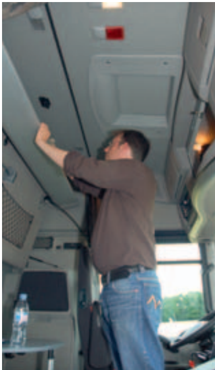
Ein weiteres Highlight beim Magnum 2008 ist das in der Rückwand integrierte Großstaufach mit Overhead-Klappmechanik.
