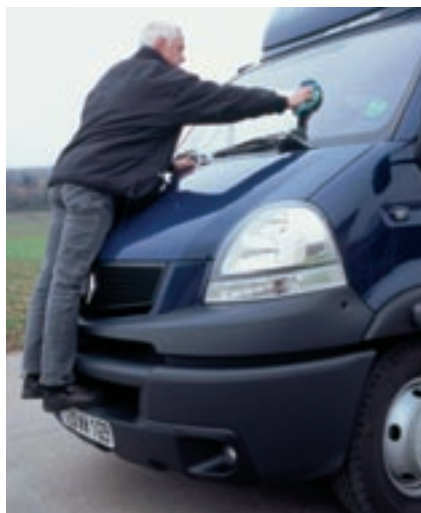
Mascott-Plus: Trittstufen im Stoßfänger, sonst langt der Fahrer nicht mehr an die Frontscheibe.
