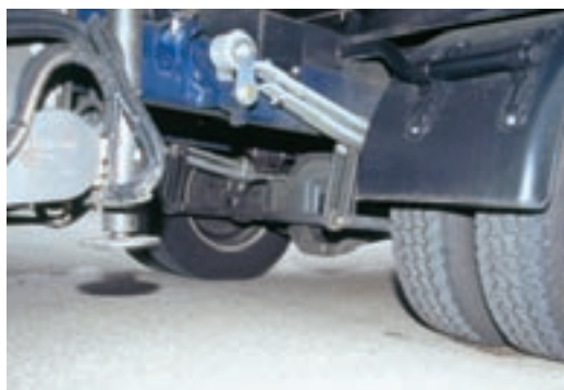
LKW-Technik I: tragender Rahmen, Zwillingsbereifung und Hinterradantrieb LKW-Technik II: Reserverad und großer Kraftstofftank rechts des Leiterrahmens
