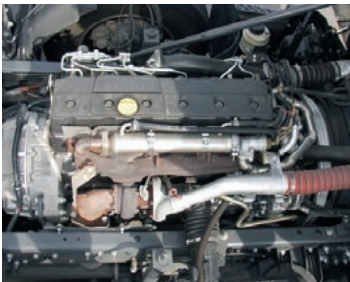
Der 6-Zylinder-Reihendiesel mit 6,2 l Hubraum leistet 265 PS und verfügt über ein Drehmoment von 900 Nm.
