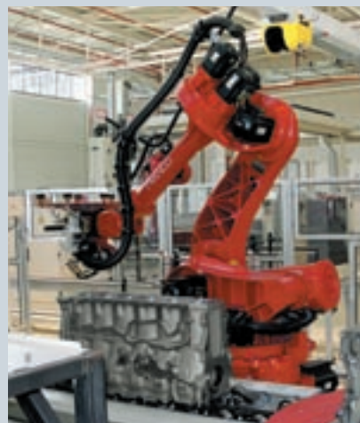
High-Tech im Motorenbau: die neue Fertigung in Vénissieux
