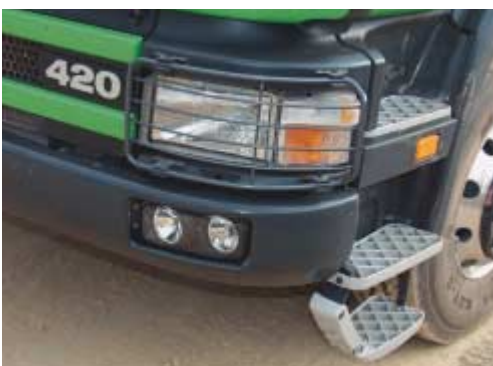
Der „C“-Scania ist mit Stahlstoßstange, Lampenschutzgitter und beweglicher unterer Trittstufe ausgerüstet
