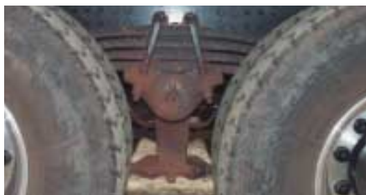
Mit vier 41 mm dicken Blättern: 19 t Parabelfederung hinten
