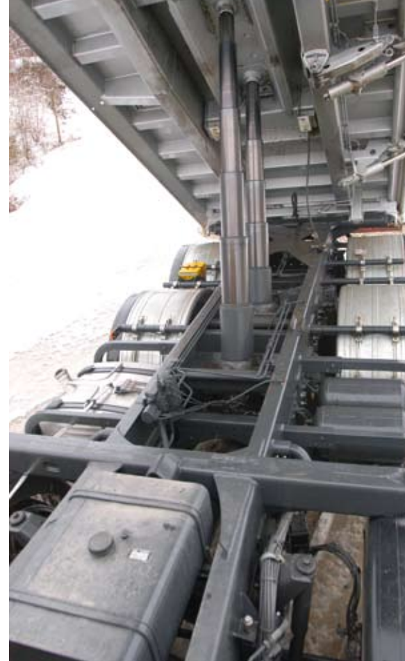
Zwei Hydraulikstempel ohne Stabilisator – schwerer Meiller-Aufbau für skandinavische Erfordernisse
