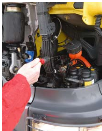
Althergebracht: Ölkontrolle noch mit dem Peilstab
