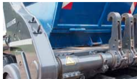
Adonis-Absetzer von Gergen: Mit drei Kippklappen kann er jeden handelsüblichen Behälter leeren. Oben: Wenig Platz, aber perfekte Ergonomie – der Gergen-Aufbau wird per Funkfernbedienung gehandhabt.
