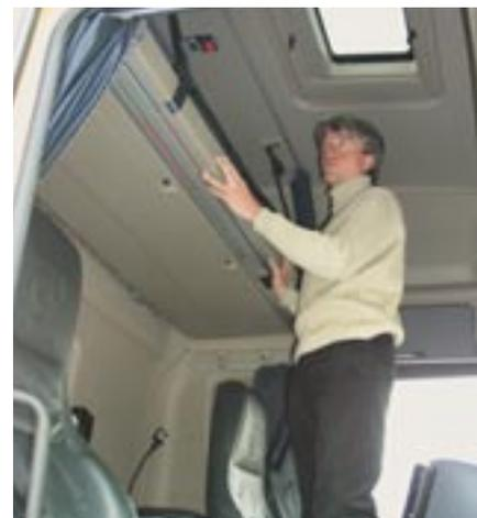
Im Vergleich zum Vorgänger befinden sich im Topline jetzt das obere Bett wieder konventionell an der Rückwand und über der Windschutzscheibe geräumige Staufächer
