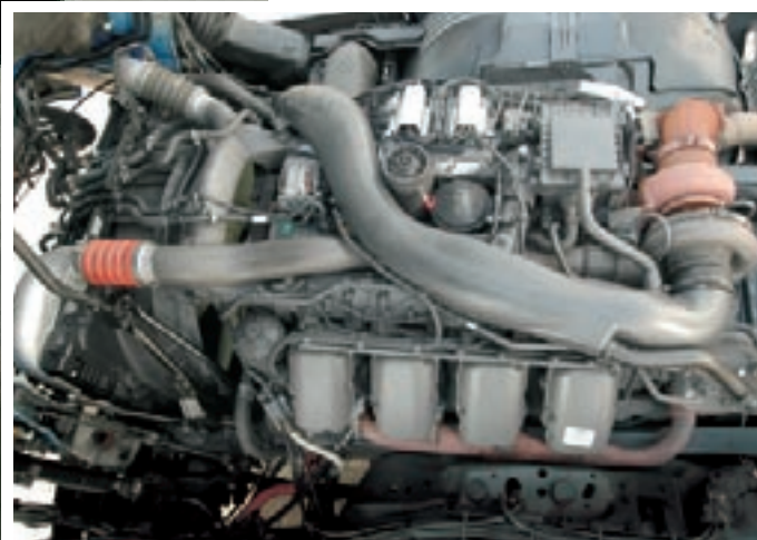
Das V8-Powertriebwerk DSC 16 04 mit 500 PS bei 1.900/min und maximalem Drehmoment von 2.400 Nm bei 1.100 bis 1.300 min.
