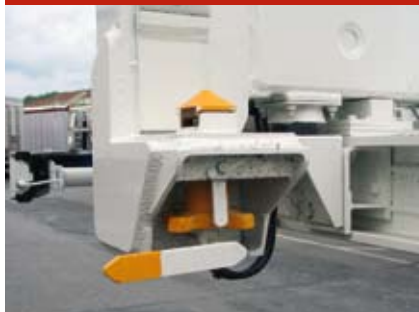
Einfach und wirkungsvoll: Drehzapfen-Lageanzeige
