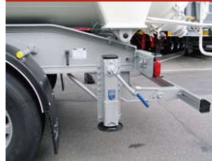
Abstütztechnik mit Jost-Modul und Luftfeder-Hub-Senkventil
