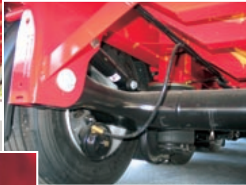
Bremsleitung auf dem Achsrohr
