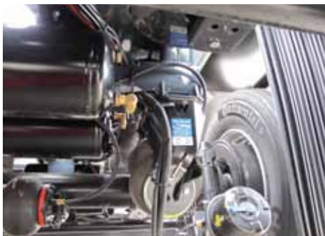
Eine von drei: liftbare Valx-Lenkachse
