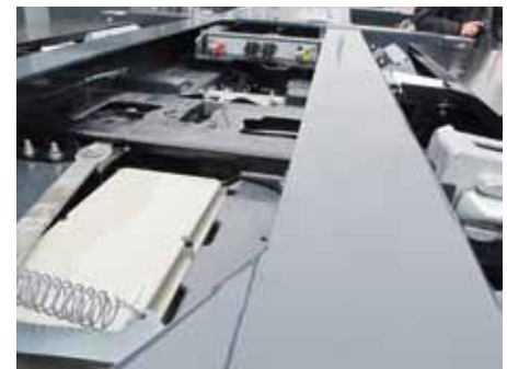
Sattelkupplung mit Jost-Verschlusstechnik
