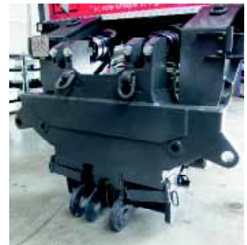
Sattelhalbs-Kupplungstechnik des Combimax; oben: Tieflbett ausgebaut
