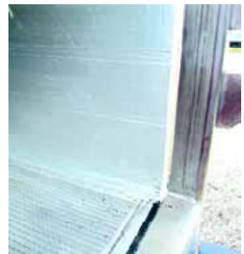
Die kritische Ecke: Bodenauflage, Seiten-Rammschutz und Heckportal
