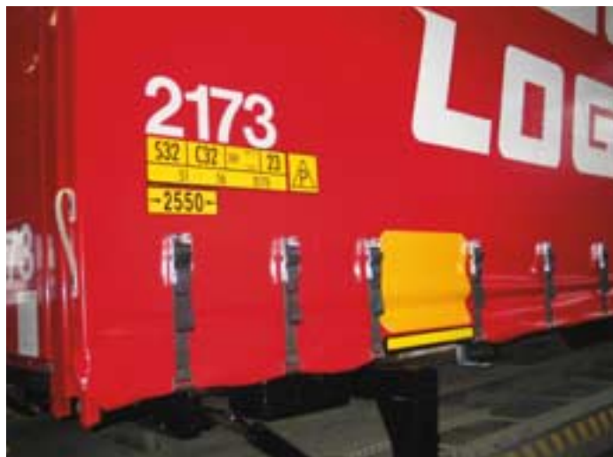
Aramidplatte statt Klappblech gegen die Greiferarme
