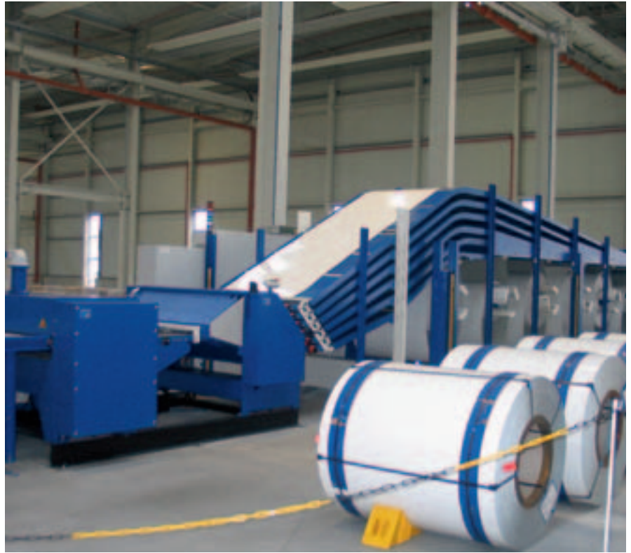
Abwicklung. Die Deckschichten-Zuführung
