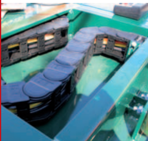
Energiekette für den 45-ft.-Ausschub
