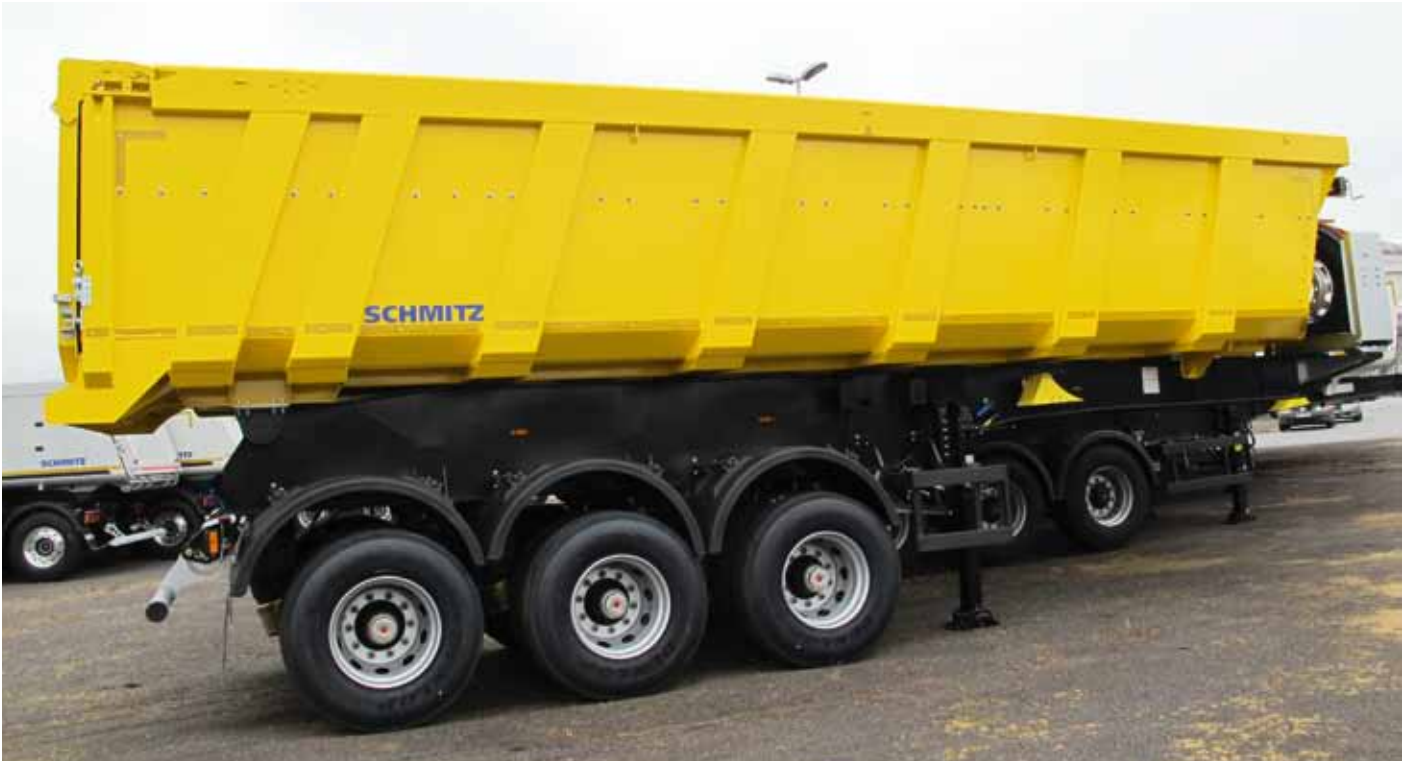
Schwere Ausführung mit 39-t-Aggregat
