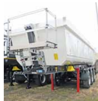
Light-Stahlmulde mit Light-Chassis: unter 5 t Leergewicht
