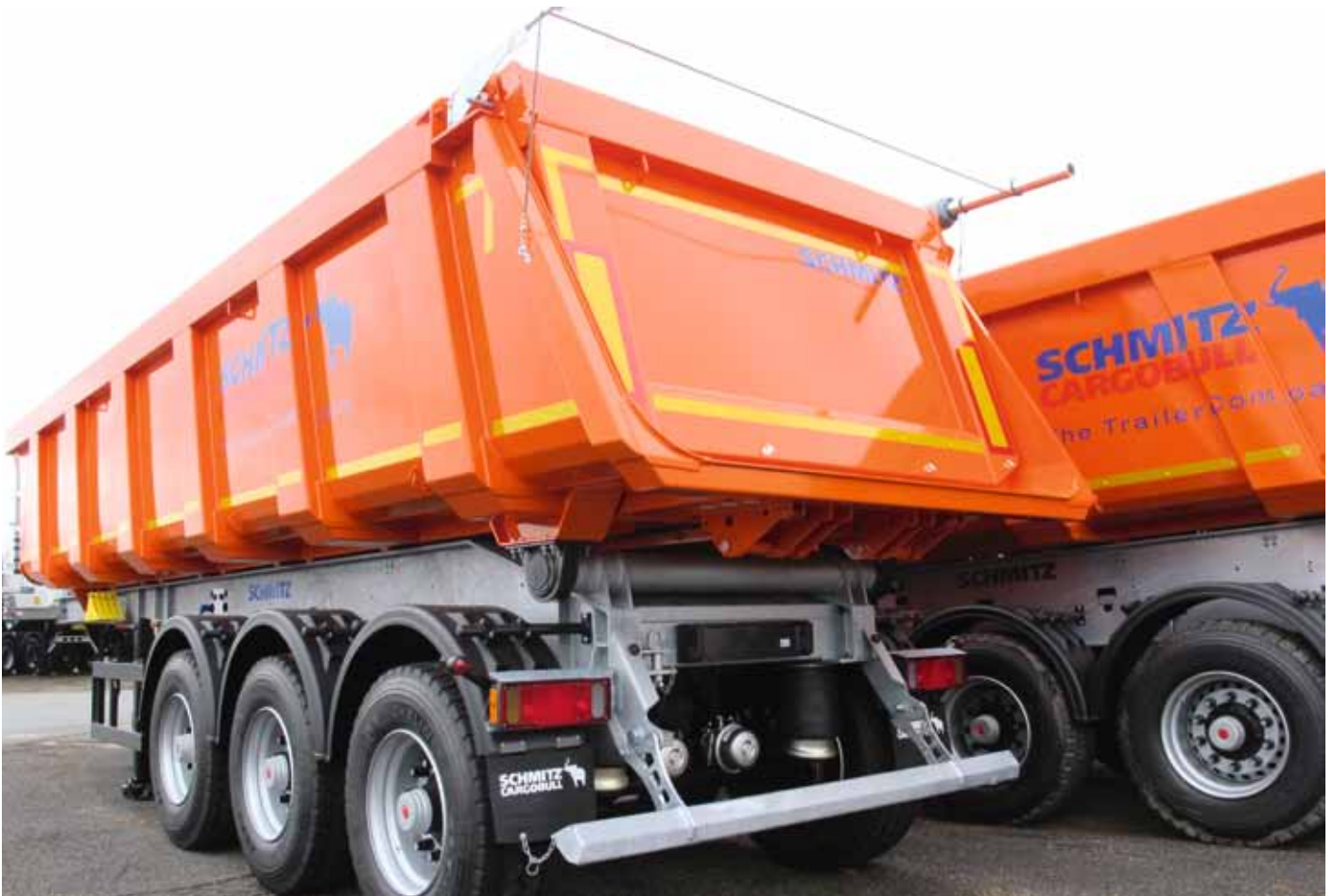
Stahl-Spantenmulde mit 27-t-Aggregat
