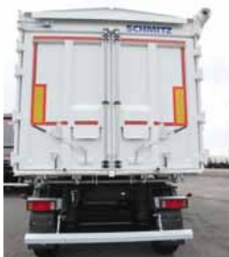
Neu im Programm: Baustoff-Drehschemelanhänger; Kombitür mit Getreideschiebern (unten)
