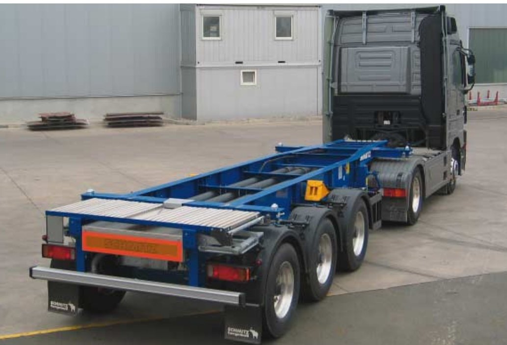
Tankerchassis 20 ft. mit Wanne und Schlauchrohren
