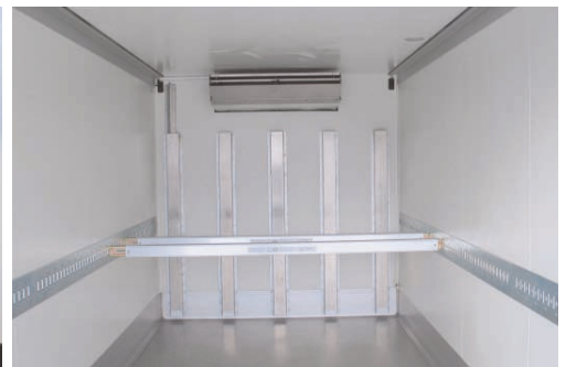
Standard-Rückluftkanäle, im Bodenhöhe verstärkt
