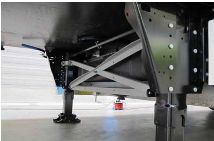
Hinter dem Stützenwerk: Kunststofftank für das Kühlgerät
