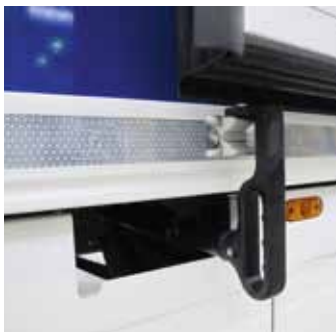
Neuer Türversteller: sperrt die Drehstange.
