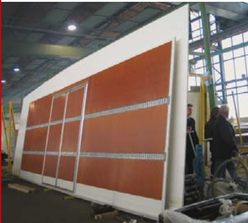
Arbeitsintensiv: Sperrholz-Seitenwand mit Zurrseilen und Tür; Stückzahlbringer KEP; wird neu gebaut: KEP-Box-Fertigung
