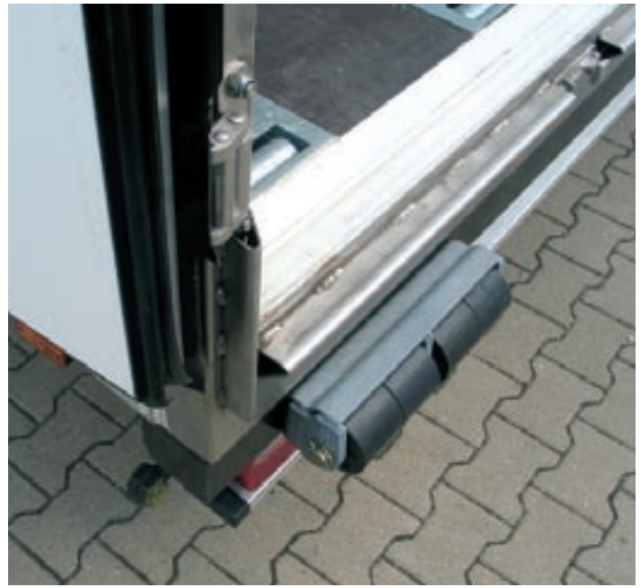
3 mm Zusatzpuffer am FNA-Portal
