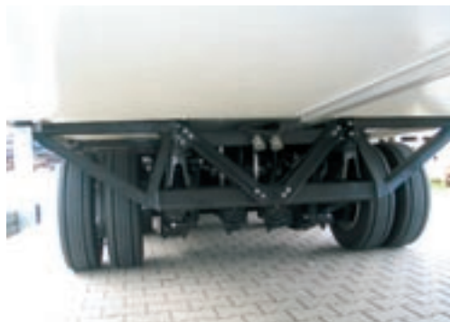
Diagonales: Achsaufhängung beim FNA
