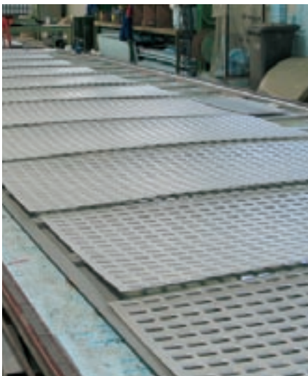
Zusammenbau: Talfix-Paneele vor dem Vernieten
