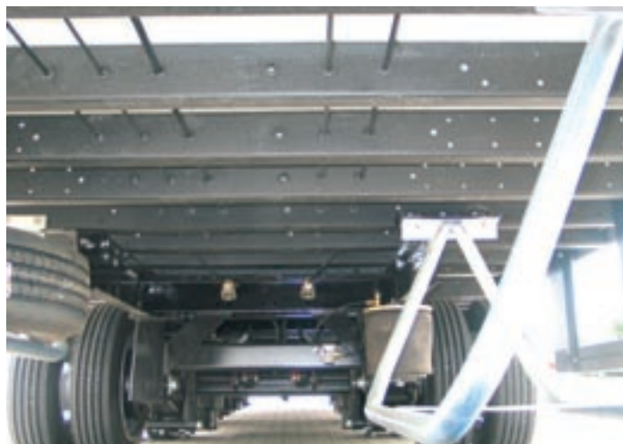
Geradliniges: Unterbau am Trockenfrachter
