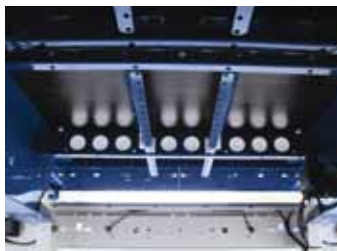
Heckabschluss von innen gesehen. Oben: Viel Platz für Anbaugeräte an den Längs-Z-Trägern
