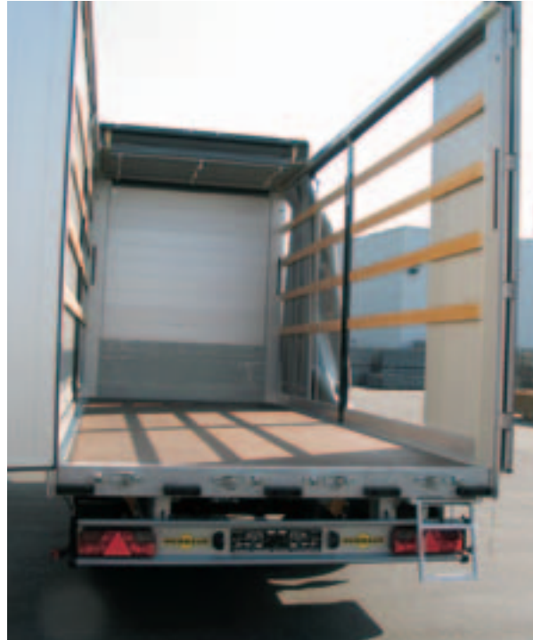
Aufgemacht: TSE-Aufbau, vollverzinktes Humber-Chassis Serie 11000
