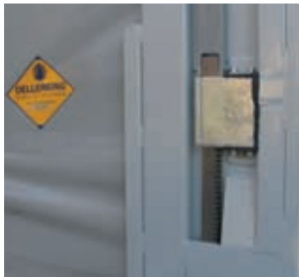
Entwickelt und gebaut: Zahnstangen-Hubmechanik für das Dach
