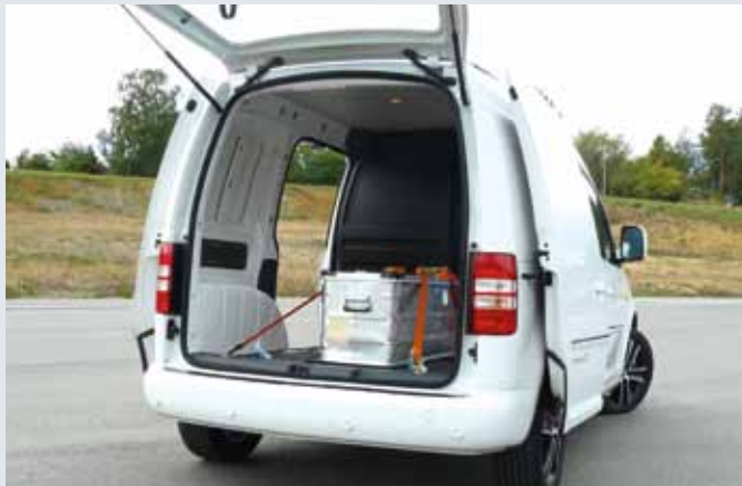
Sportler als Nützlich: Der Laderaum fasst unverändert 3,23 m 3 , der Caddy trägt eine dreiviertel Tonne Fracht.
