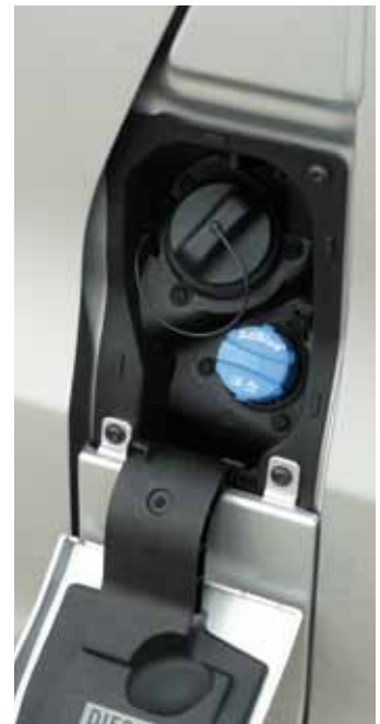
Der Fiat Talento bringt von Renault SCR-Technik und einen großen Adblue-Tank mit.
