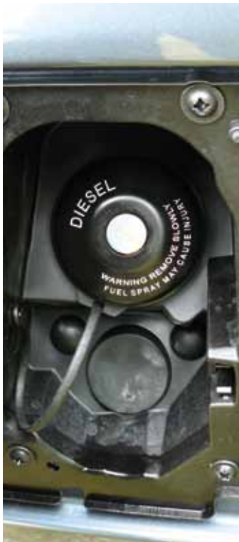
Fiat verzichtet bei LKW-Zulassung auf SCR-Technik, dann gibt es nur einen Blindstopfen statt der Adblue-Einfüllöffnung.
