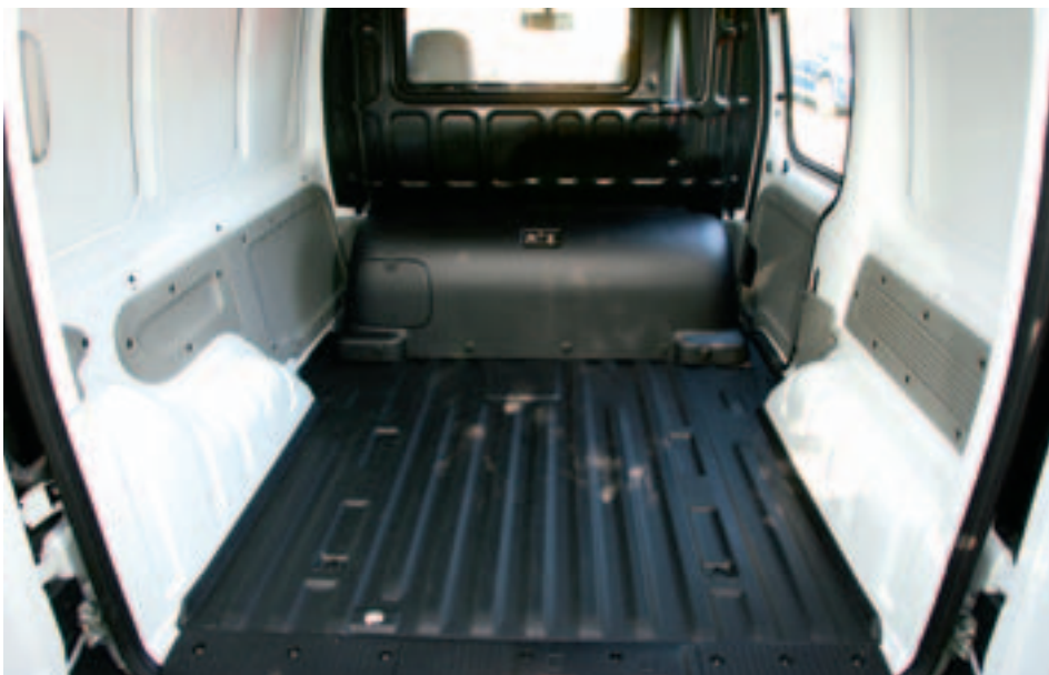
Bei Citroen und Renault machen sich die Gasbehälter im Laderaum breit.
