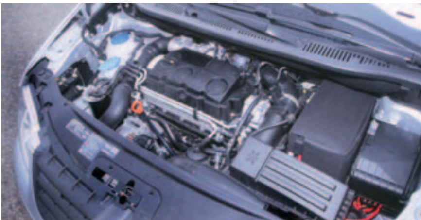
Rauer Pumpe-Düse-TDI, doch mit überarbeiteter Einspritzregelung, abgesenktem Leerlauf und neu übersetztem Getriebe
