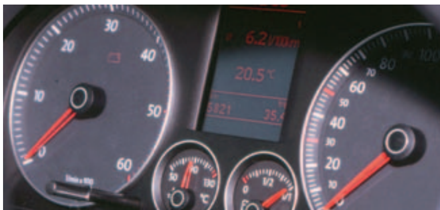
Der Bordcomputer gehört zur Sparausstattung. Der Drehzahlmesser zeigt im Blue Motion dank langer Übersetzungen plötzlich ein ganz anderes Niveau.
