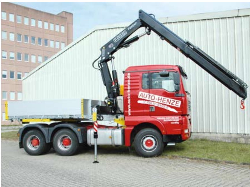
Wechselbarer Kranaufbau von Fassi: je nach Bedarf Kranfahrzeug oder Sattelzugmaschine
