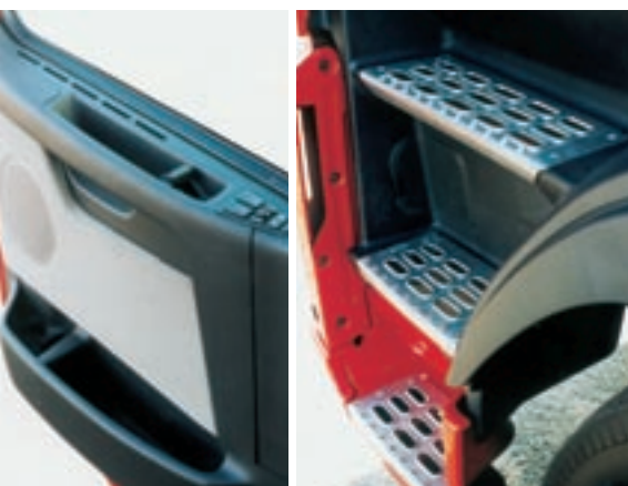
Alles im Griff: der Hebel an der richtigen Stelle (links) überzeugt nicht: glatte Kanten an den Trittstufen
