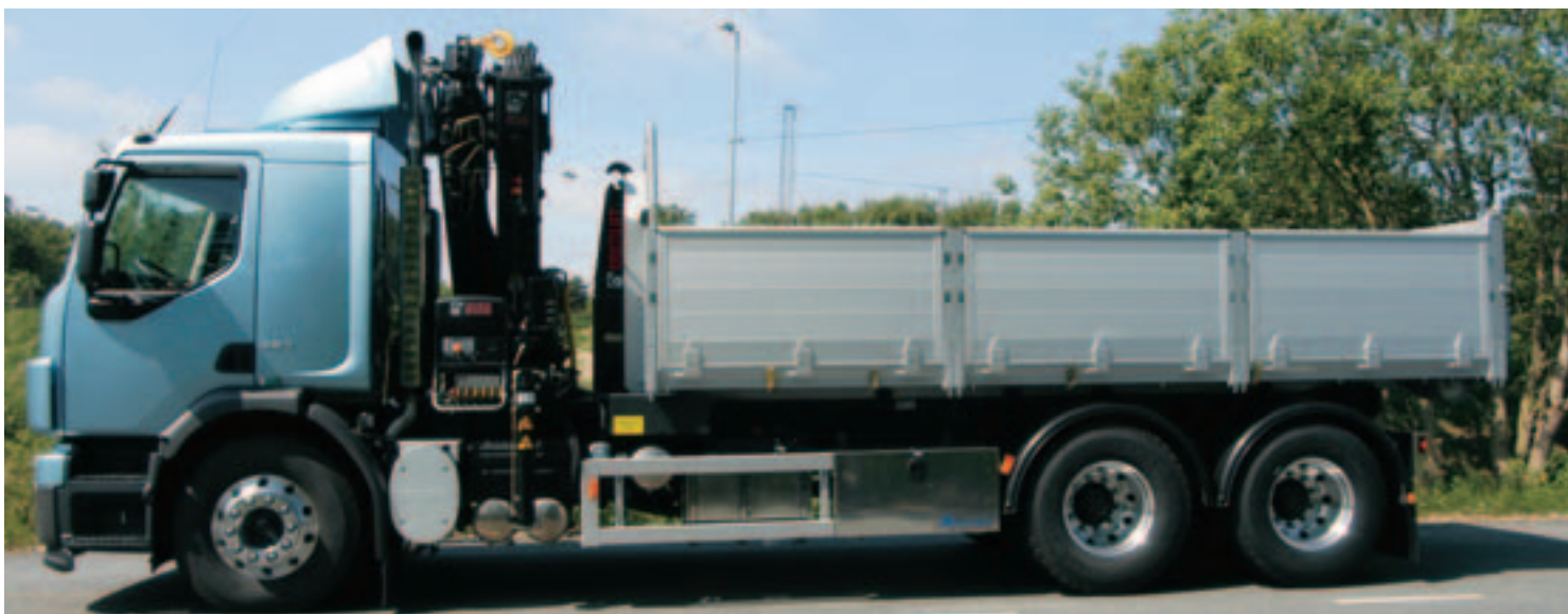
Gewichtsoptimierter Dreiaxser mit Ladekran, Hakenlift und langem Radstand – für den Antrieb sorgt ein leichter Sechszylinder.
