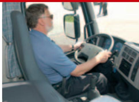
**Wenig Kompromisse:** Die ins Armaturenbrett integrierte Schalt- und Bedienkonsole ist sehr ergonomisch, blockiert jedoch den Überstieg zur Beifahrertür.
