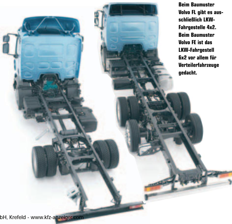
Beim Baumuster Volvo FL gibt es ausschließlich LKW-Fahrgestelle 4x2. Beim Baumuster Volvo FE ist das LKW-Fahrgestelle 6x2 vor allem für Verteilerfahrzeuge gedacht.
