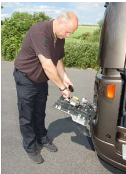
Praktisch: Birnenwechsel ohne Werkzeug
