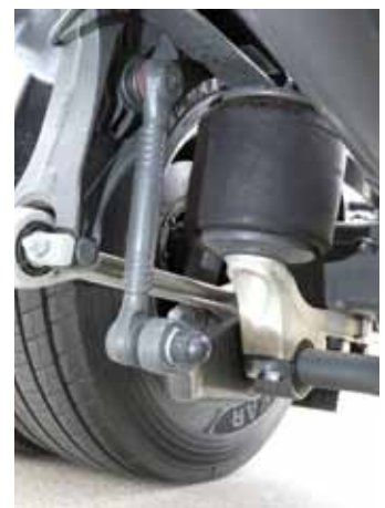
Optimierte Hinterachse, jetzt mit Balgträgern und Längslenkern aus Aluminium.
