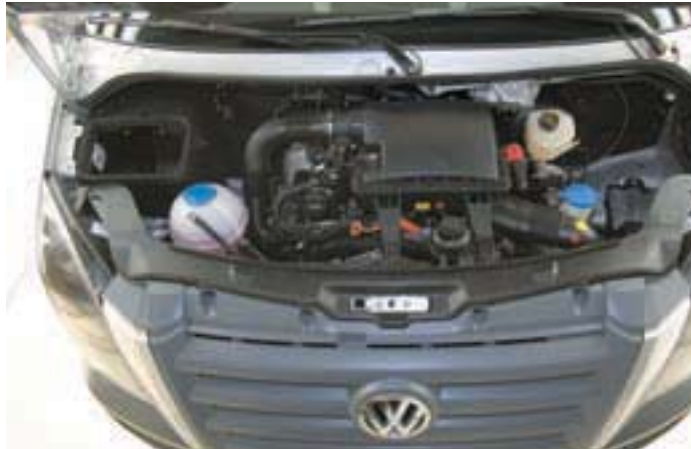
TDI pur: Durchweg kommen Fünfzylinder mit 2,5 Liter Hubraum zum Einsatz.
