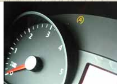
Typisch Start-Stopp: Drehzahlmesser in Stellung null, Infolämpchen informiert über den freiwillig abgestellten Motor.
