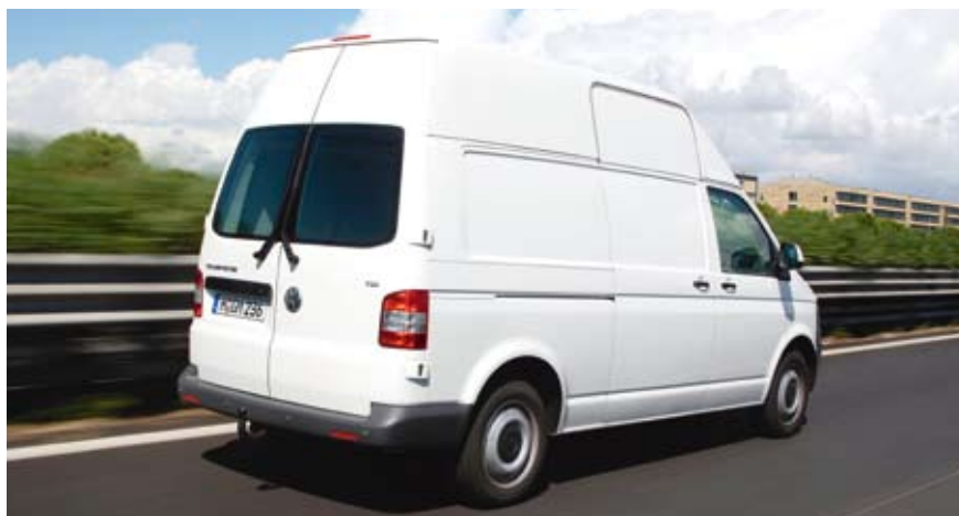
Unter dem Hochdach ist Platz für 9,3 m 3 Fracht. Wer wirklich laden will, wählt nicht 2,8 sondern 3,0 oder 3,2 t Gesamtgewicht.
