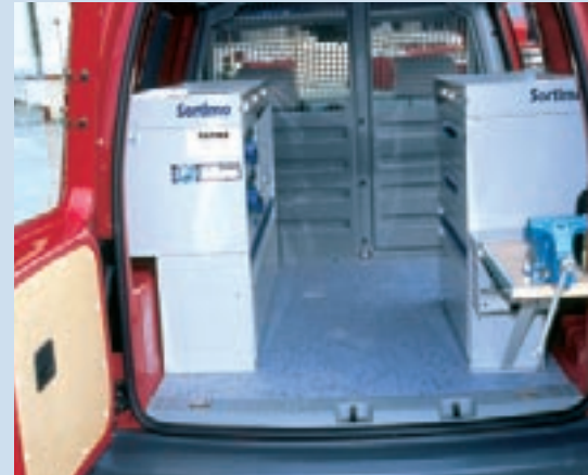
Raumfüllend: Sortimo verwandelt den Laderaum des Caddy in einen schmucken Werkstättwagen.
