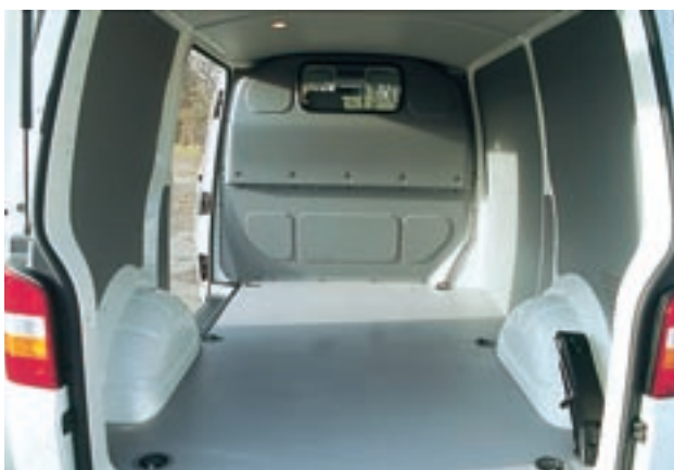
(links) Am T5-Arbeitsplatz: Gute Sitze und sparsame Ausstattung (rechts) Glatte Flächen im 5,8 m 3 fassenden Laderaum, sechs massive Zurrösen zur Ladungssicherung
