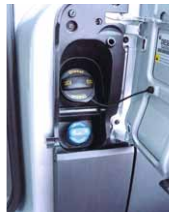
Zur Abgasreinigung setzt VW auf eine neue Hochdruck-Abgasrückführung sowie SCR-Technik mit Adblue-Einspritzung.
