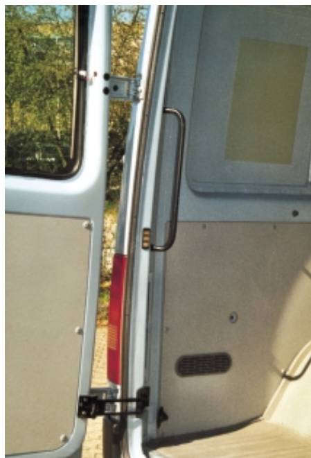
Beide Flügeltüren auf 180 Grad geöffnet geben eine sehr große Türöffnung frei (Bild ganz oben) Reduzieren die Nutzlast: Holzboden mit Belag und Seitenverkleidung (oben) Gute Idee: Einstiegshilfe am hinteren Türholm (rechts)
