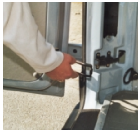
Keine schmutzigen Finger beim Entriegeln des Türfeststellers
