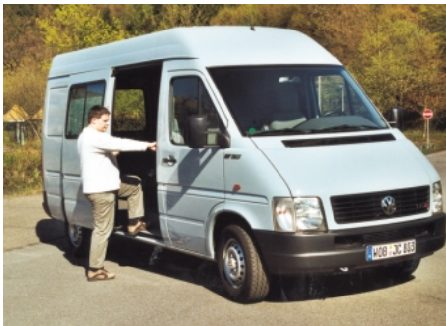
Akzeptabel: Einstieg mit 435 mm bis zur ersten Stufe
