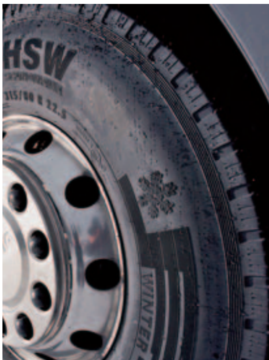
Die Winterreifen-Familie von Continental umfasst die Reifentypen HSW Scandinavia, HDW und HDW Scandinavia. (oben) Neben der M+S-Kennzeichnung hat Continental die Winter-spezies mit Schneeflockensymbol und dem Begriff „Winter“ intern zertifiziert. (unten)
