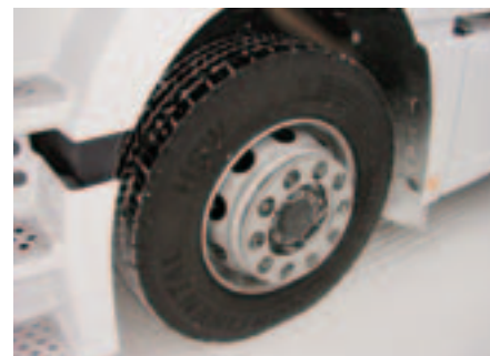
Der HDW Scandinavia besitzt dank Kettenlamellenprofil eine ausgezeichnete Traktion und hohe Seitenführungskräfte auf Schnee und Eis (oben rechts). Der HSW Scandinavia auf der Vorderachse sorgt für beste Lenk- und Bremskontrolle sowie für nochmals verkürzte Bremswege (unten rechts).
