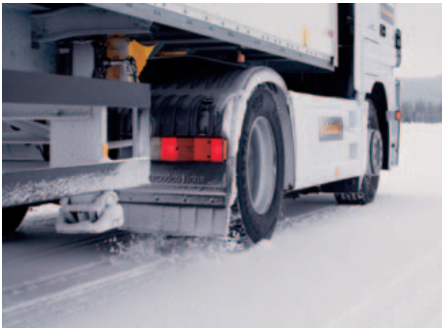
Der HDW Scandinavia besitzt dank Kettenlamellenprofil eine ausgezeichnete Traktion und hohe Seitenführungskräfte auf Schnee und Eis (oben rechts). Der HSW Scandinavia auf der Vorderachse sorgt für beste Lenk- und Bremskontrolle sowie für nochmals verkürzte Bremswege (unten rechts).
